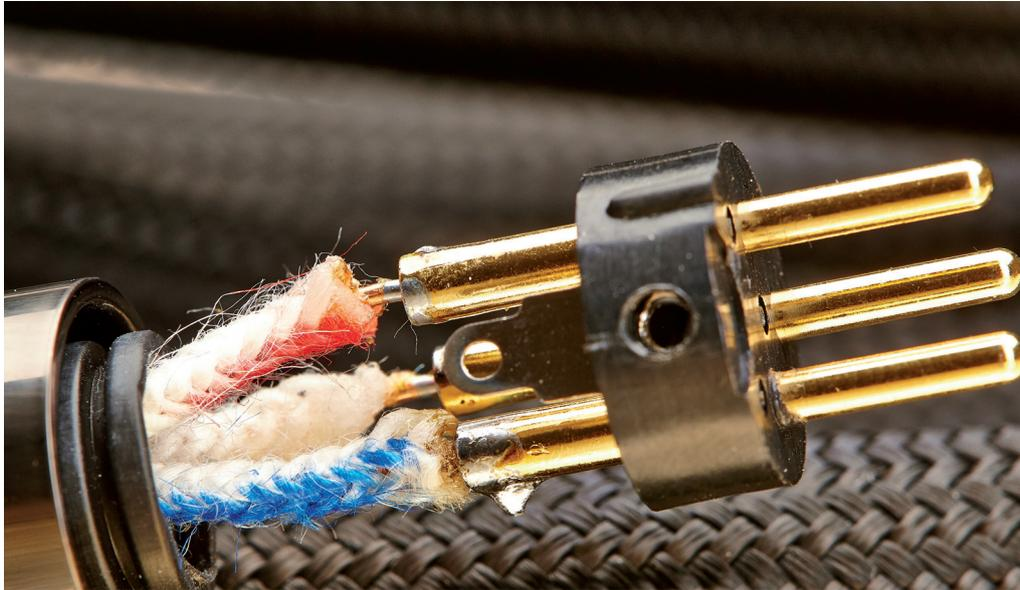
*Man kann deutlich erkennen, dass keine synthetischen Polymerkunststoffe als Isolationsmaterial verwendet werden*
