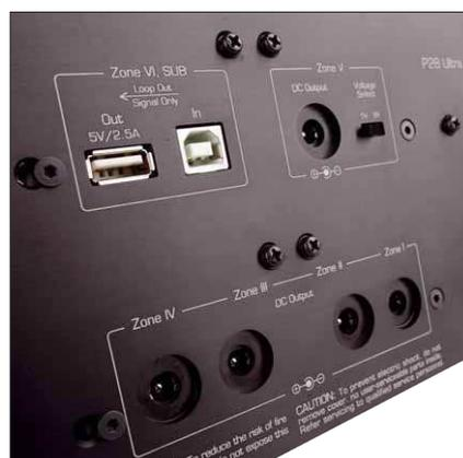
Der USB-Loop trennt Spannungs- und Datensignal der Verbindung von Streamer und DAC
