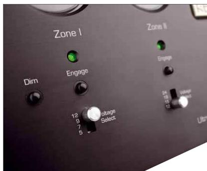
Mit den Schaltern an der Front lässt sich die Spannung der einzelnen Zonen bequem wechseln
